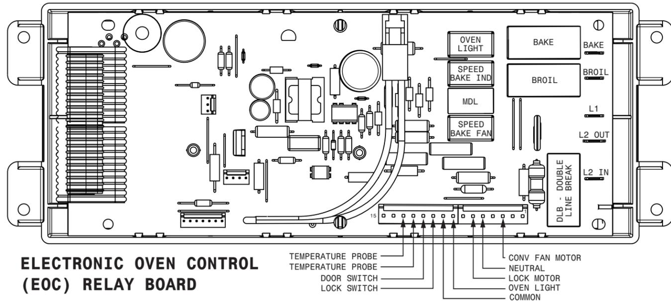
**ELECTRONIC OVEN CONTROL (EOC) RELAY BOARD**
